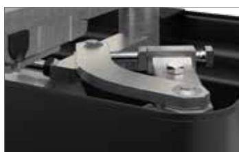
Finecorsa con regolazioni di alta precisione
