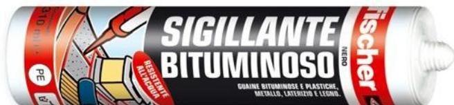
**Sigillante Bituminoso** è un sigillante adesivo a base di bitume elastoplastico applicabile a freddo. Il materiale una volta rappreso, è plastico e riagglomerante e in caso di rottura si autoripara. Garantisce applicazioni durevoli e resiste all'immersione in acqua permanente.
