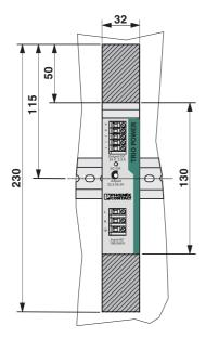
Posizione d'installazione: Ingombro compatto 115 mm (+ guida di supporto)
