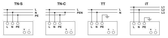
Il collegamento 100 V AC ... 240 V AC avviene mediante le connessioni a vite L, N e PE.
