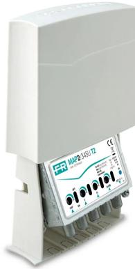
Amplificatore con 4 ingressi (III+DAB, IV, V, UHF) da palo con guadagno 25dB e livello di uscita fino a 116dB $\mu$ V in banda UHF, amplificazioni separate VHF/UHF, regolazioni del guadagno (0-15dB) indipendenti per ogni ingresso e bassa figura di rumore. Tecnologia T2 con filtro integrato per eliminare le interferenze 5G a 694MHz.
