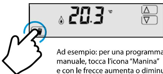
Ad esempio: per una programmazione manuale, tocca l'icona "Manina" e con le frecce aumenta o diminuisce la temperatura impostata.
